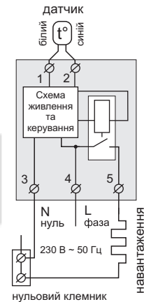
Схема 1. Спрощена внутрішня схема і схема підключення
