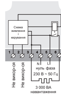
Схема 1. Спрощена внутрішня схема і схема підключення
