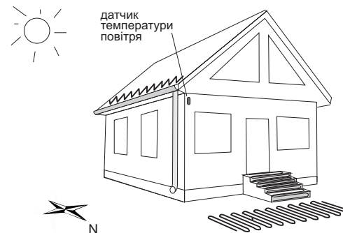
Рисунок 1. Монтаж датчика температури повітря
