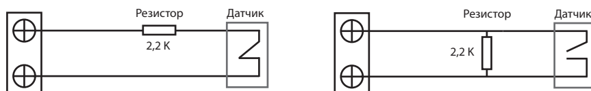
Подключение для нормально закрытых контактов Подключение для нормально открытых контактов
