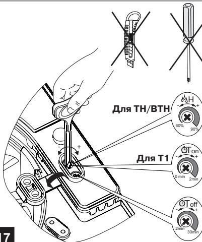
$\Theta_{\text{on}}$  Для регулировки времени задержки включения вентилятора поверните ручку потенциометра  $\Theta_{\text{on}}$  по часовой стрелке для увеличения и против часовой стрелки для уменьшения времени задержки включения соответственно (от 0 до 2 минут).
