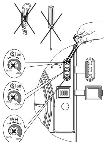
**T<sub>on</sub>** Для регулировки времени задержки включения вентилятора поверните ручку потенциометра **T<sub>on</sub>** по часовой стрелке для увеличения и против часовой стрелки для уменьшения времени задержки включения соответственно (от 0 до 2 минут).
