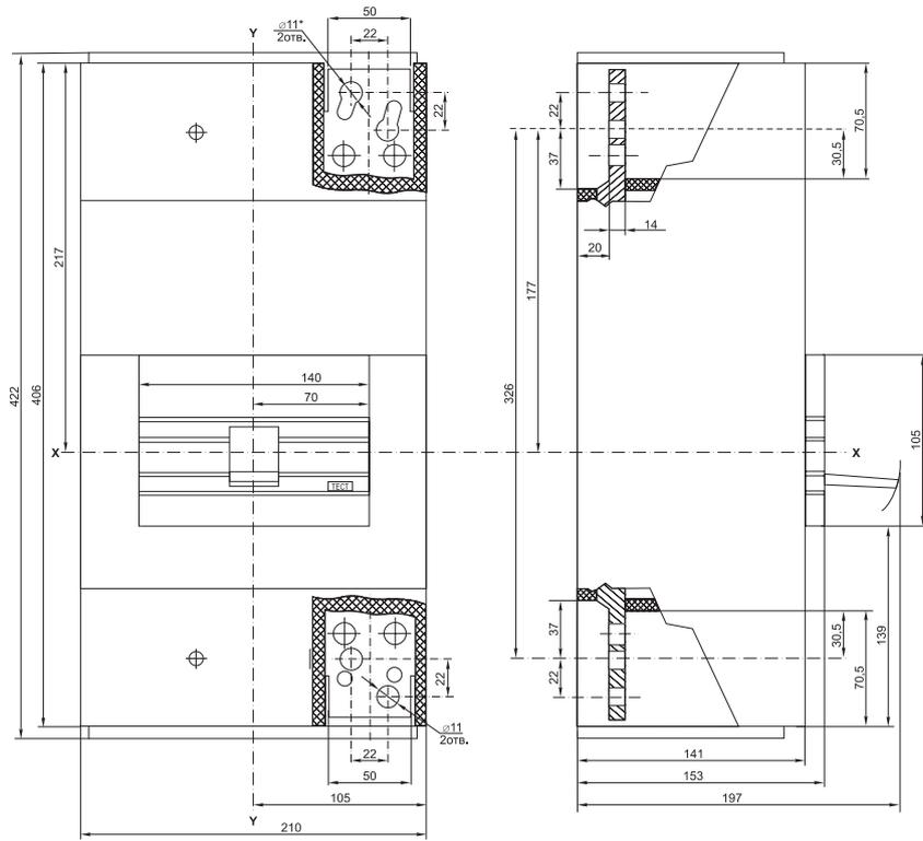
\*Отверстия предназначены для крепления наконечника-переходника
