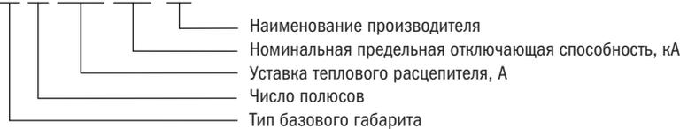
Пример обозначения выключателя при заказе и в документации другого изделия: выключатель автоматический в исполнении 33-го габарита трехполюсный на номинальный ток 125 А с номинальной предельной отключающей способностью 35 кА торговой марки IEK® – ВА88-33 3Р 125А 35кА ИЭК.
