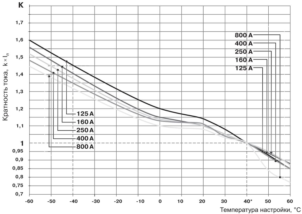
Характеристика токоограничения выключателей при напряжении 400 В
