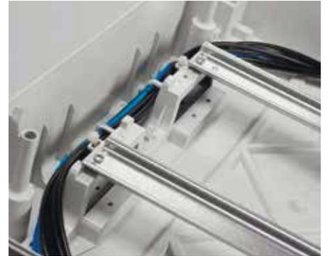
Для упрощения протяжки проводов, были увеличены расстояния под DIN-рейками и сбоку шкафов. Также предусмотрены места крепления стяжками к основанию бокса.
